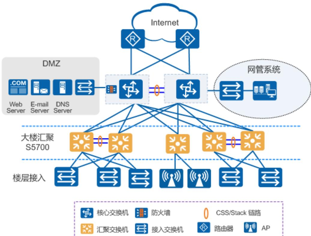
在企业网络和园区网中，CloudEngine S5731-S 通过千兆/百兆接口接入交换机，提供高性能大容量交换，上行通过万兆光口接入核心交换机，构成万兆骨干、百兆到桌面的企业网全网解决方案，满足用户高带宽、多业务的需求。
