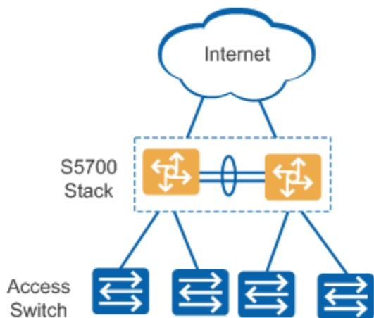
CloudEngine S5731-S 使用智能堆叠技术，可以多台设备互相备份，保障核心设备的高可靠性。支持丰富的用户接入控制策略，用户集中管理，简化配置。
